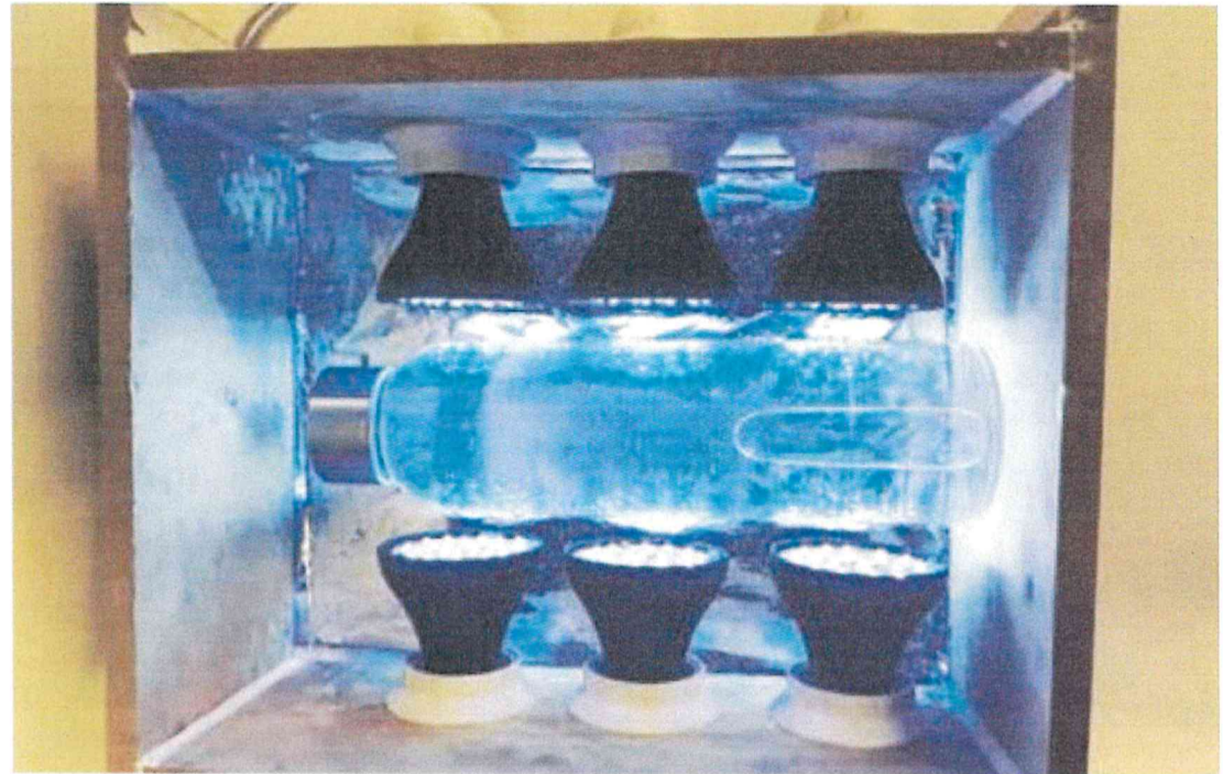
La société Solable utilise les rayons UVA dans ses purificateurs d'eau. PASCAL NUTI
